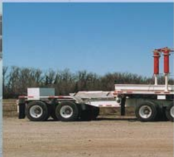
40MVA, 117.5/21.6x12.47kv移动电站制造于美国电力系统, NOMEX高压真空绝缘材料绝缘式变压器。
