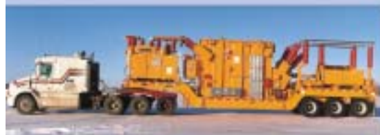
17.1MVA; 115x69/34.5 x 13.8 KV NOMEX高温混合绝缘材料使用在移动变电站系统
